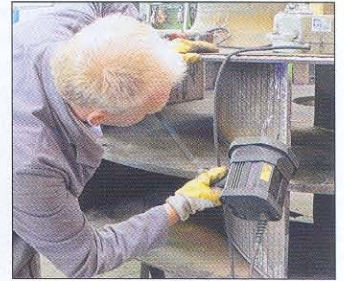
Links: Laufrad eines Groß- ventilators auf der Drehbank und während der Schweiß- arbeiten an den Flügeln Kontrolle der Schweißnähte
