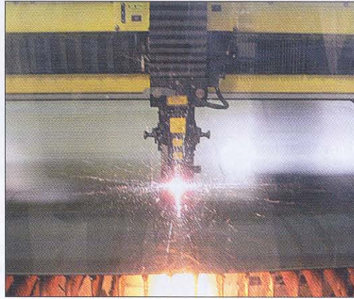
Hinter der Schutzhaube schnei- det moderne Lasertechnik nach Bauplan vollautomatisch und hoch präzise
