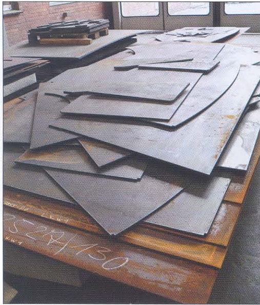
„Lufttechnik-Bausatz“ in Oelde: Auf Paletten zusammengestellte Teile nach Zuschnitt mit Kom- missions-Nr.
