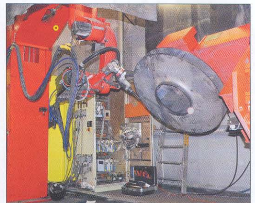
Schweiß- roboter an einem kleineren Laufrad
